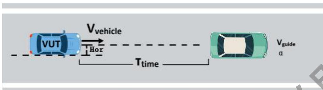
图 34 前车制动场景示意图
